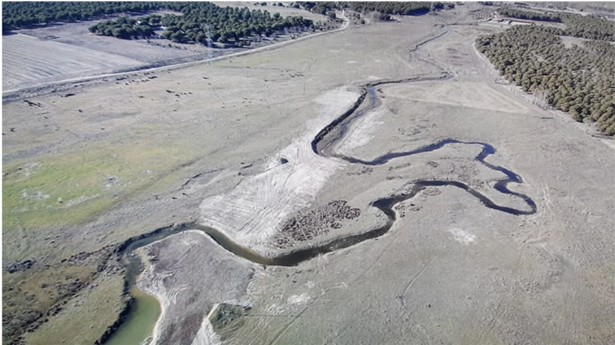
Fotografía 10. Restauración de la continuidad transversal en las márgenes del cauce del río Zapardiel mediante la descanalización y recuperación de brazos viejos.
