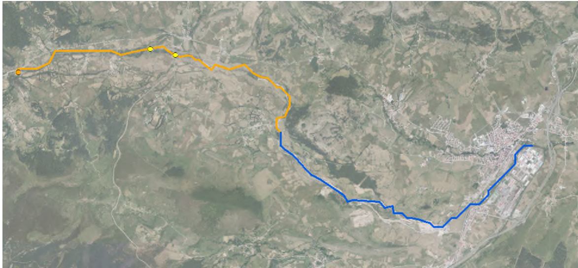
Figura 35. Proyecto de restauración fluvial en el río Híjar. En azul se muestra el tramo de actuación del proyecto, correspondiente a las actuaciones continuas ejecutadas en los tramos medio y urbano (8 km). En color naranja se representa el tramo adicional en el que se mejora la continuidad, que discurre desde el obstáculo existente aguas arriba del último obstáculo permeabilizado en la obra y que se suma al tramo de actuación del río Híjar hasta su desembocadura en el Ebro para el cálculo de la longitud de río conectado. Los dos puntos amarillos indican la ubicación de los obstáculos permeabilizados con el proyecto.
