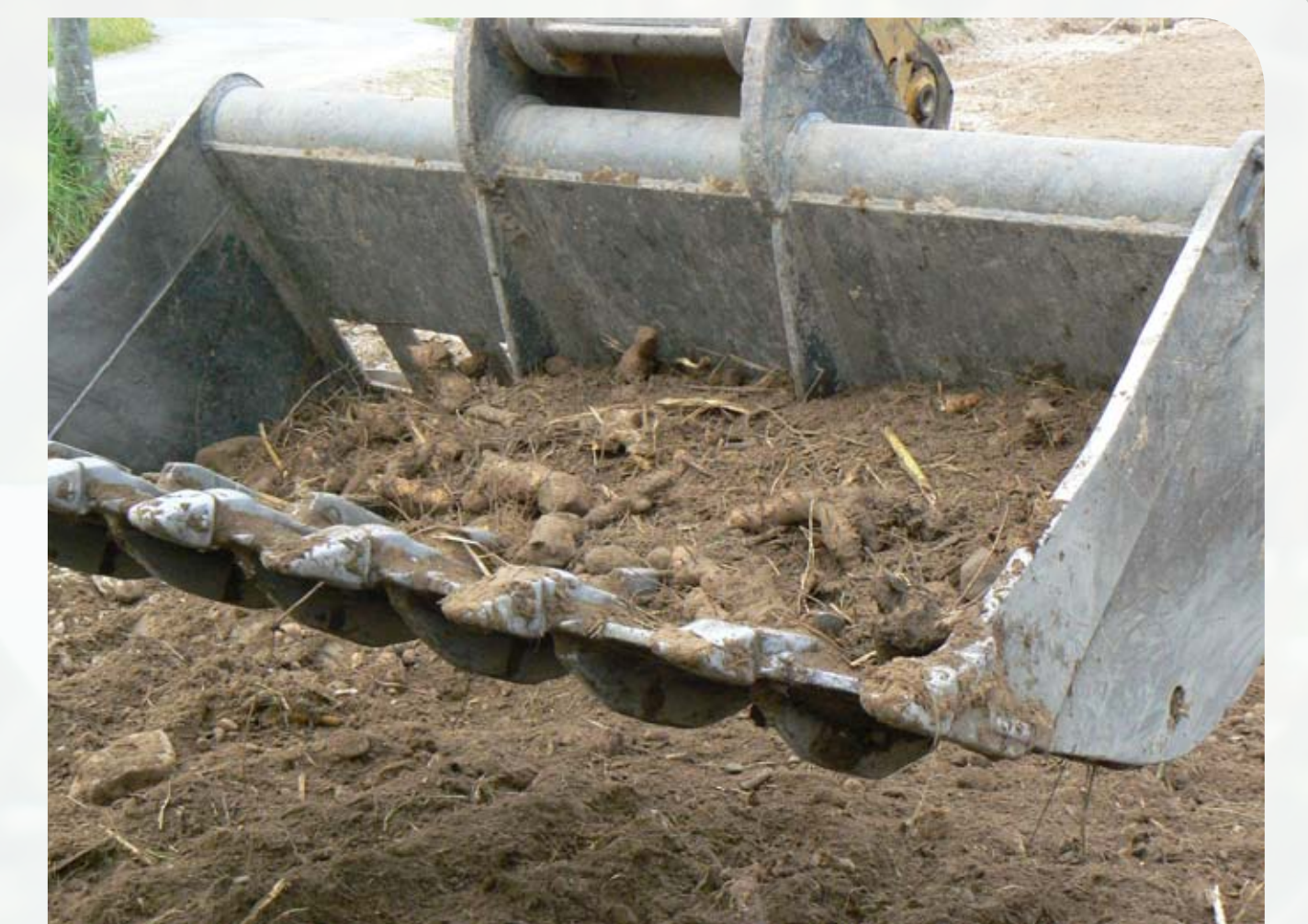
Figura 6. Extracción de rizomas mediante el cribado de sustrato con un cazo modificado.
