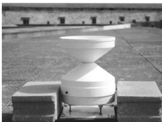
Figura 1. Pluviómetro de balancín
