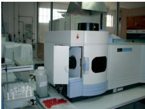
Las técnicas analíticas utilizadas pueden influir en los resultados. En la imagen analizador plasma y cromatógrafo (Foto IPROMA)
