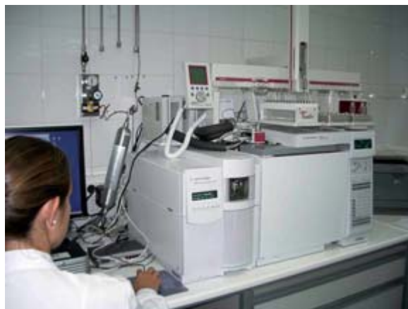
Las técnicas analíticas utilizadas pueden influir en los resultados. En la imagen analizador plasma y cromatógrafo (Foto IPROMA)
