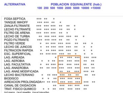
Alternativas de tratamiento según rango de población de Arriate (6370 heq), Jimera de Líbar (1116 heq), Cortes de la Fra. (5020 heq) y El Colmenar (1197 heq)
