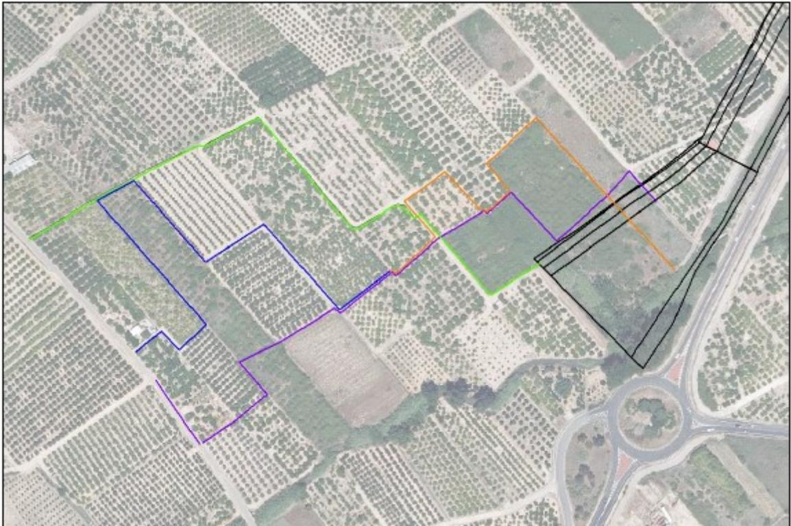
*Alternativas estudiadas para trazado en planta del muro de protección.*
