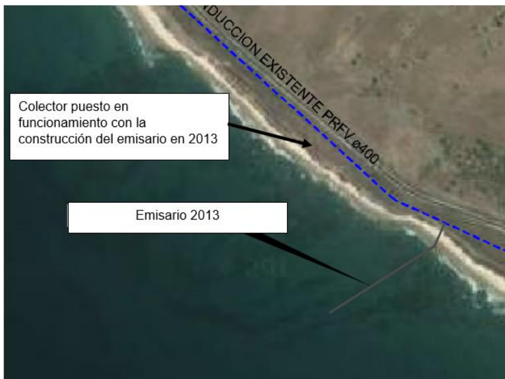
Ilustración 4: Planta proyecto nuevo punto de desagüe 2013.
