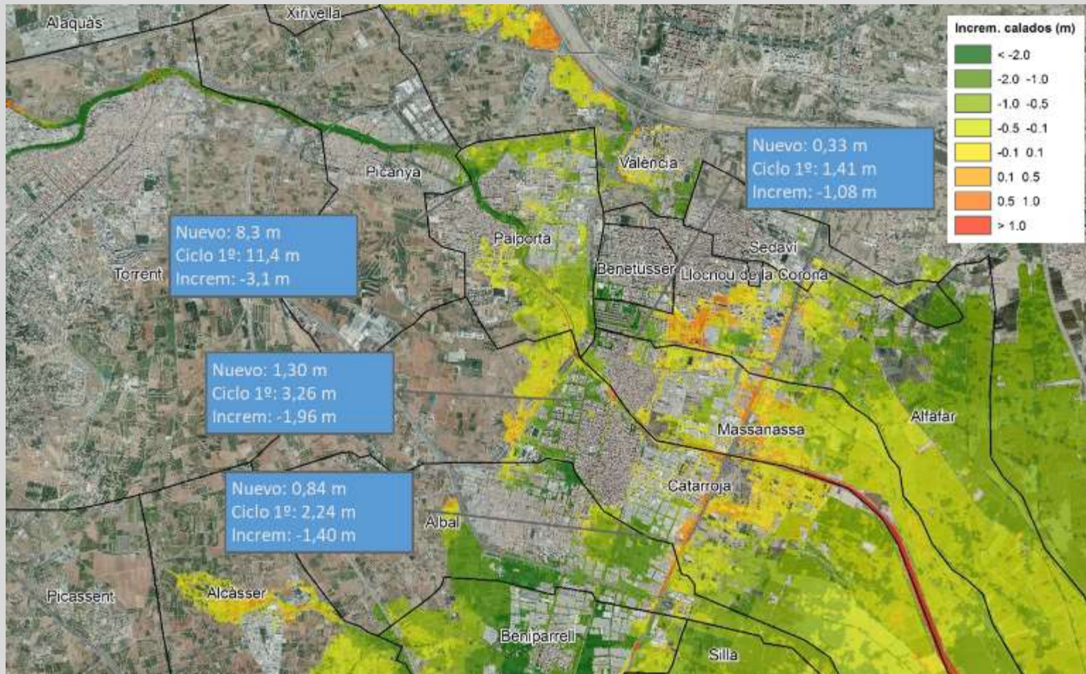
Ejemplo: resultados aplicados en la Rambla del Poyo. Incremento calados máximos para T500 años.
