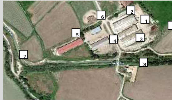
Edificaciones y elementos de la explotación (1 nave de recepción; 2,3,4 y 5 naves de cebo; 6 cubierta; 7 caseta de bombeo; 8 depósitos de agua potable; 9 estercolero)
